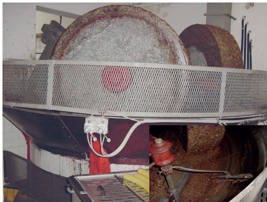
Figura 4. Molino a molazze in azione e particolare della vasca.
