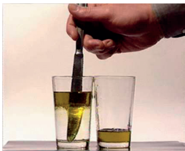
Figura 10. Semplice esperimento semplificato per la comprensione del sistema Sinolea.
