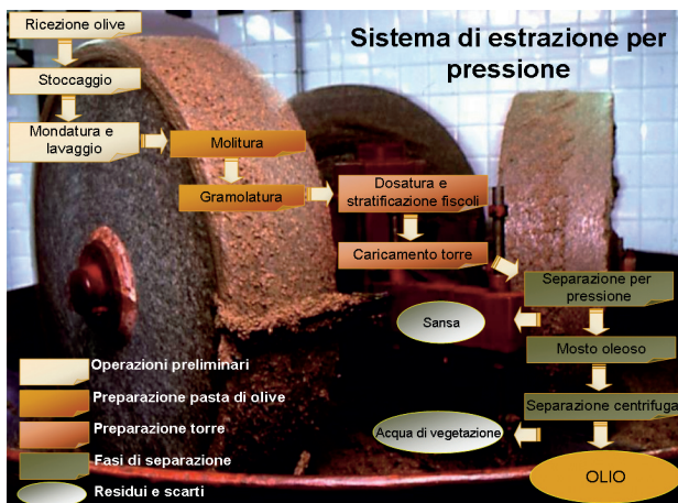
Figura 6. Diagramma di flusso di un sistema di estrazione tradizionale per pressione (sullo sfondo particolare di un molino a molazze in azione).
