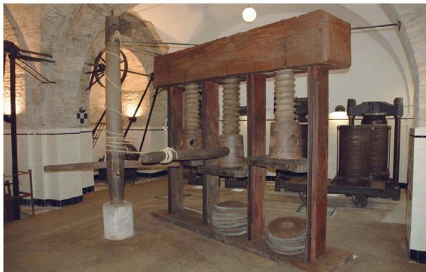
Figura 2. Torchio a tre viti senza fine (in olmo) presso il Museo dell'Olio di Loreto Aprutino (PE).
