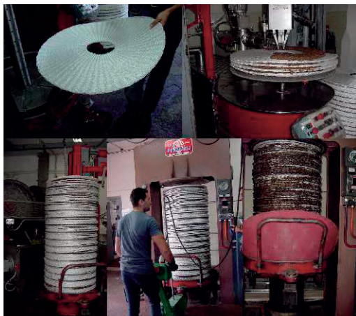
Figura 7. Particolari della dosatrice fisolatrice e della pressa idraulica: 1-fiscolo, 2-dosatura-stratificazione della pasta di olive e impilamento della torre; 3-una torre di fiscoli completata; 4-caricamento della torre sotto la pressa idraulica; 5- pressione della torre di fiscoli ad opera della pressa.
