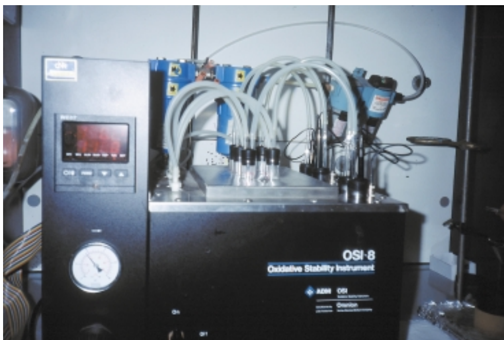
Figura 40. Strumento utilizzato per la determinazione della stabilità di un olio di oliva.
