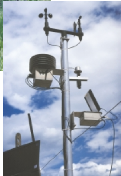
Figura 5. Particolare dei sensori per le rilevazioni microclimatiche.
