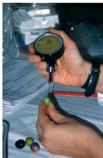
Misura della consistenza della polpa delle olive.
