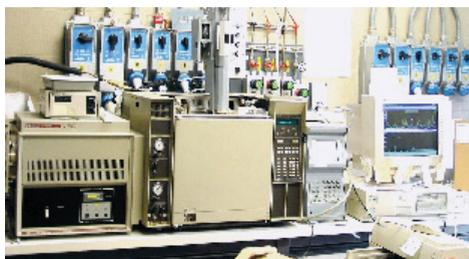
*Gascromatografo associato allo spettrometro di massa per l'analisi delle sostanze volatili aromatiche.*
