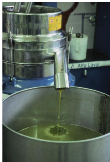
*Separazione dell'olio per centrifugazione.*
