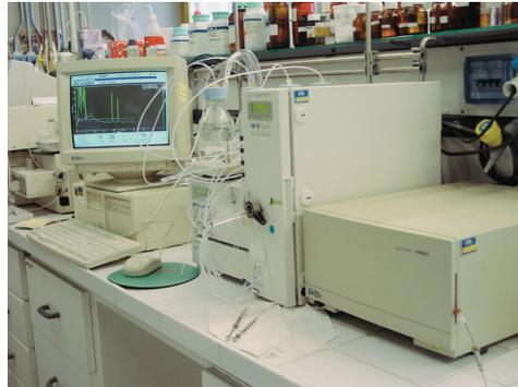
*Cromatografo liquido ad alta pressione (HPLC) per la determinazione delle vitamine e dei pigmenti.*
